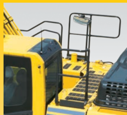
Barandillas y placas antideslizantes
